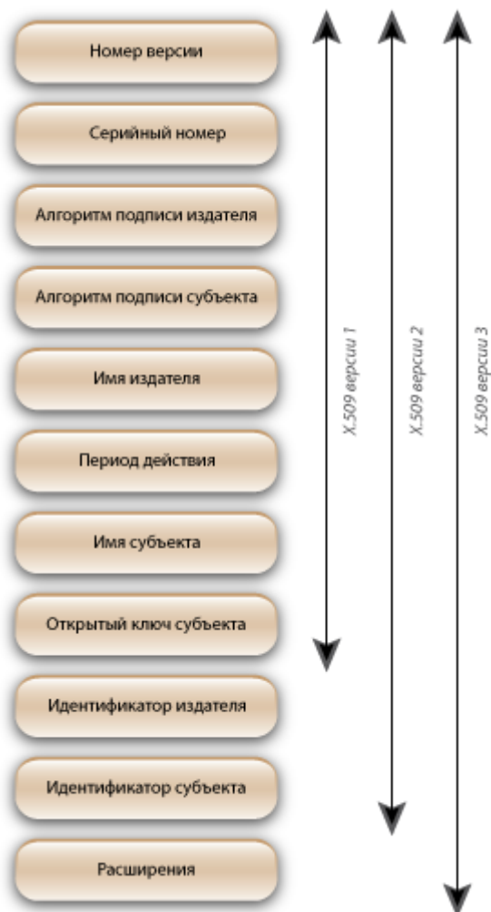
Рисунок 50: Структура сертификата, соответствующего стандарту X.509 версии 3
