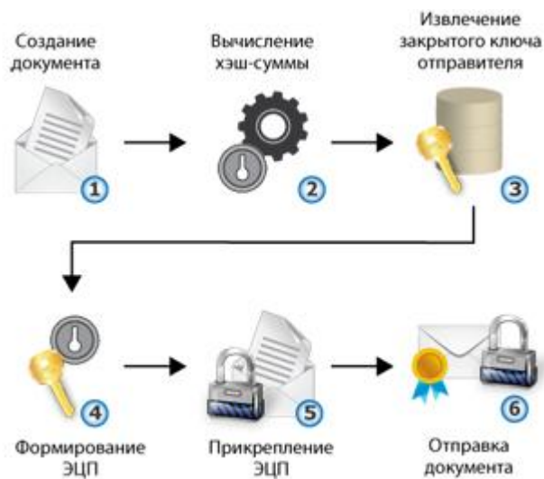
Рисунок 54: Процесс подписания электронного документа
